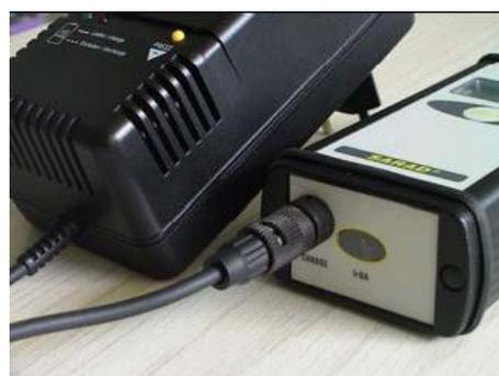
充电工具具有维护功能（LED 灯旁边按钮），使用它经常对其进行放电和充电。
