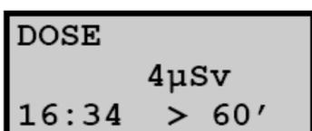
当量剂量由 PAEE 推导而来，其中使用了剂量转换系数，剂量转换系数用户可调，可以参照当地管理规章设置可靠值。
