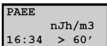
$\alpha$  潜能照射量是 PAEC 与照射时间的乘积，因此也是整个测量过程的一个积分值；PAEE 是推导剂量的基础数据。
