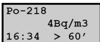
进行 Po-218 浓度的数据输出是想要以最快的速度探测到放射性浓度的变化；由于 Po-218 寿命很短，最终结果在 12~15 分钟后即可获得；Po-218 的浓度与 EEC 虽然不直接相关，但是给我们提供了第一手的、快速对测量地点的状态进行评估的可能性。
