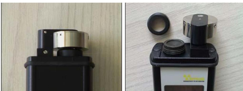
要更换滤膜，拧开探头黑色小支撑架上面螺丝，然后可以旋转探头及其支撑架 90 度，然后可以看到滤膜，将滤膜取出，注意探头不应多次来回旋转，这将导致其内部连线损伤！注意不要触碰半导体探头表面！
