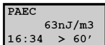
α 潜能浓度表示在一预定义的空间体积内，由氡衰变链中短寿命子体发射的能量的总和。
